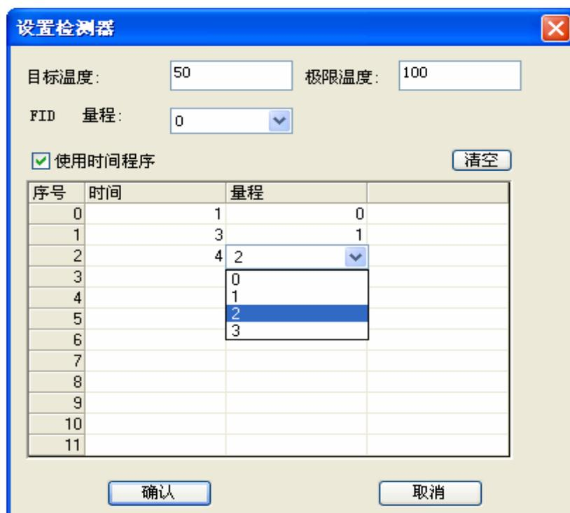
过【清空】键，可以实现一键清除检测器的量程时间程序栏内的内容，对上图进行【清空】操作后，如下图：
