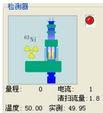
ECD 检测器控制打开状态
