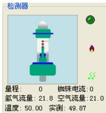
NPD 检测器控制关闭状态
