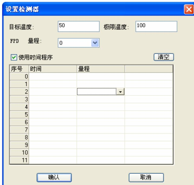
输入理想的参数值后，鼠标左键点击【确认】后，完成对 FPD 检测器各项参数的设置，关闭【设置检测器】窗口。
