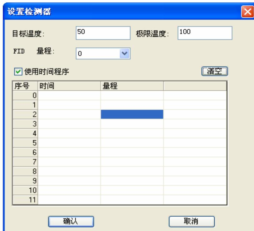
输入理想的参数值后，鼠标左键点击【确认】后，完成对 FID 检测器各项参数的设置，关闭【设置检测器】窗口。
