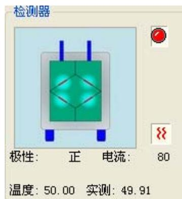
TCD 检测器打开控制状态
