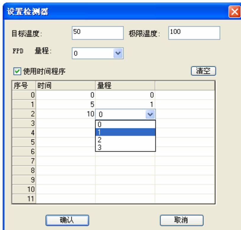
通过【清空】键，可以实现一键清除检测器的量程时间程序栏内的所有内容，对上图进行【清空】操作后，如下图：
