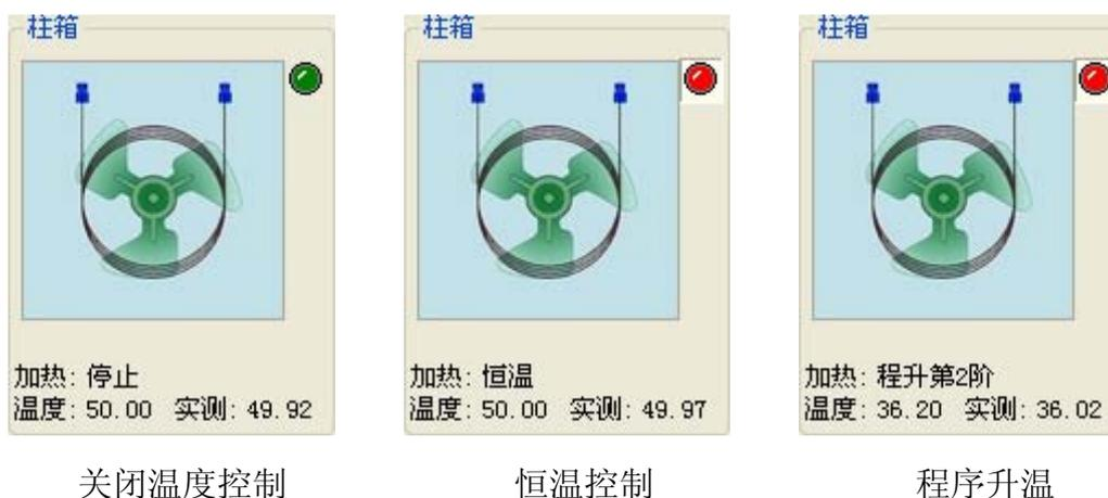
加热：显示柱箱加热状态。（分 停止、恒温、程升 三种状态）
