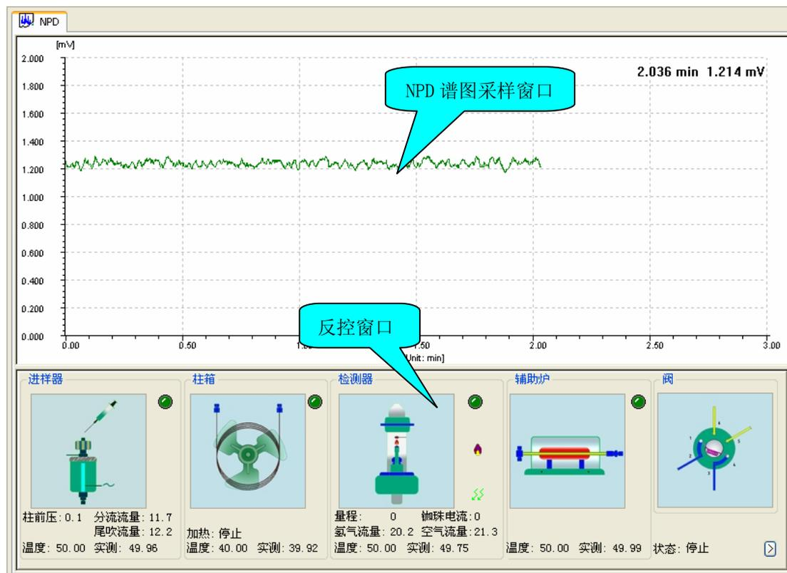
关于与 NPD 匹配的进样器、柱箱、检测器等设备的状态、设置以及控制开关都列在反控窗口中。如下图：
