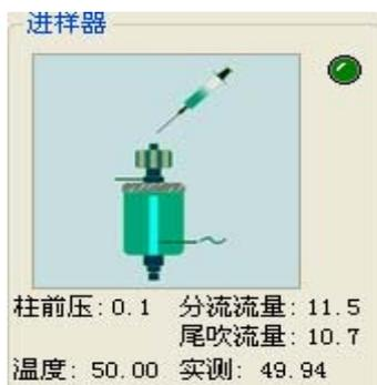
柱前压：显示的是毛细管柱前压力值。（单位：KPa 即 千帕）
