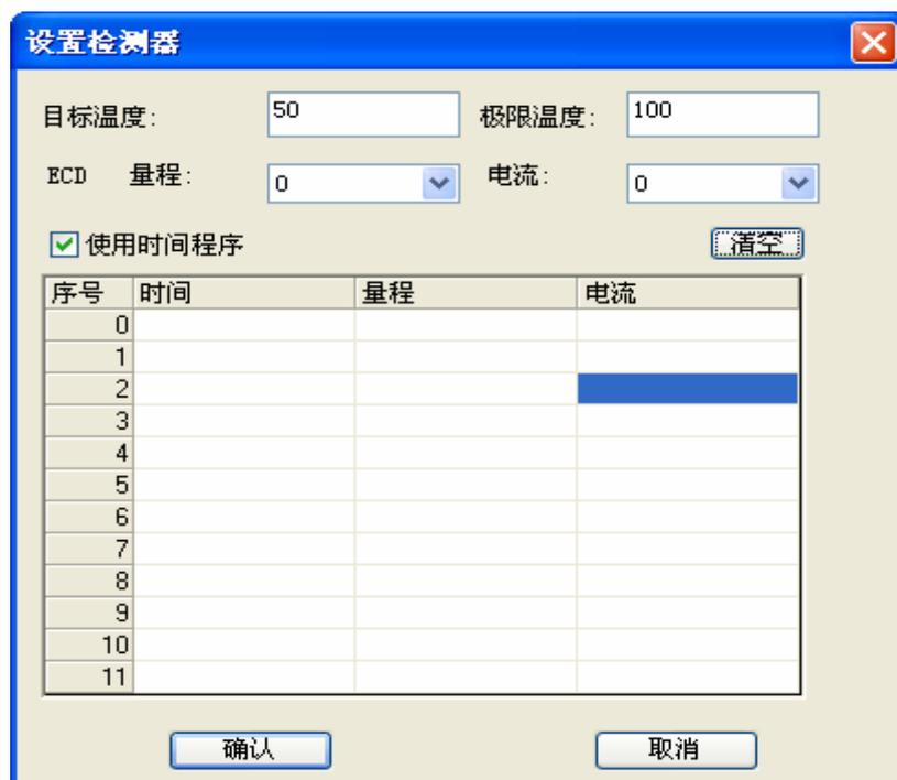
输入理想的参数值后，鼠标左键点击【确认】后，完成对 ECD 检测器各项参数的设置，关闭【设置检测器】窗口。
