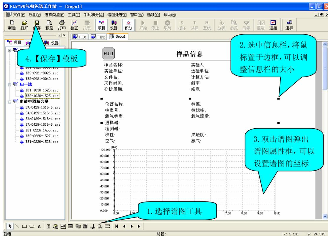
3、上图中第3点，双击报表模板或报表文件中的谱图栏，弹出谱图的【属性】窗口，可以自由设置谱图的坐标。如下图：
