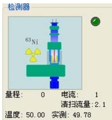
ECD 检测器控制关闭状态
