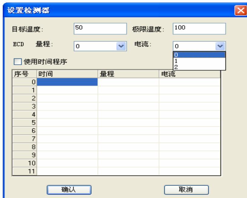
浙江福立分析仪器有限公司推出的 GC9790III型色谱分析仪器支持 ECD 检测器的量程时间程序切换和电流时间程序切换，也就是在不同的时间段对样品使用不同的量程和电流进行分析，从而得到更为准确的分析结果。
