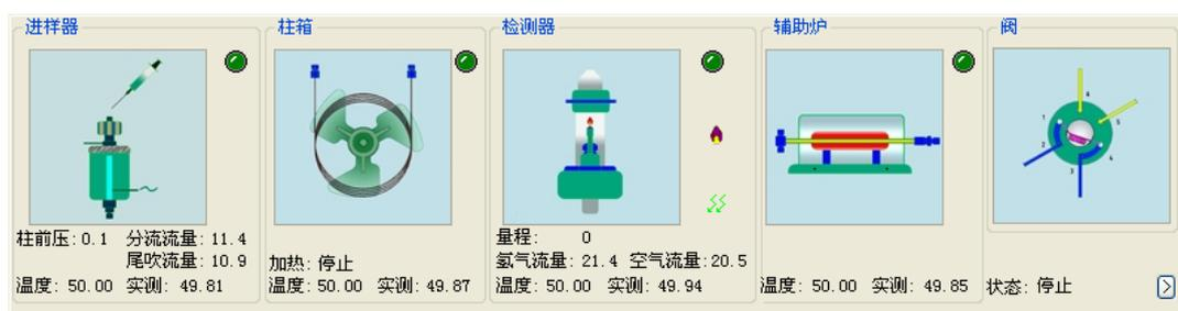
注：由于在工作站演示过程中所使用的是毛细管柱和 FID 检测器，所以反控窗口区域出现的进样器是毛细柱进样器，检测器是 FID 检测器。
