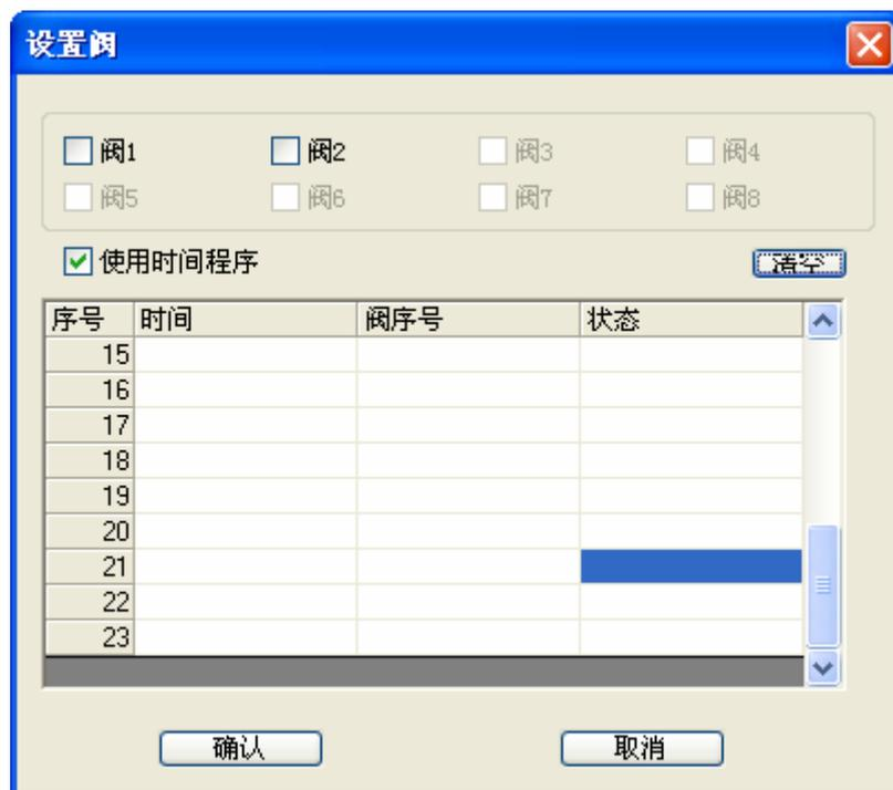
输入理想的参数值后，鼠标左键点击【确认】后，完成对辅助炉各项参数的设置，关闭【设置阀】窗口。
